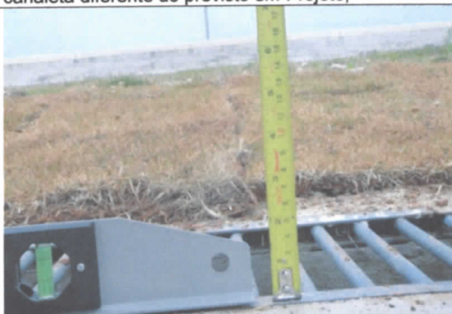
FOTO 75: Desnível entre o campo de futebol e a canaleta diferente do previsto em Projeto;
