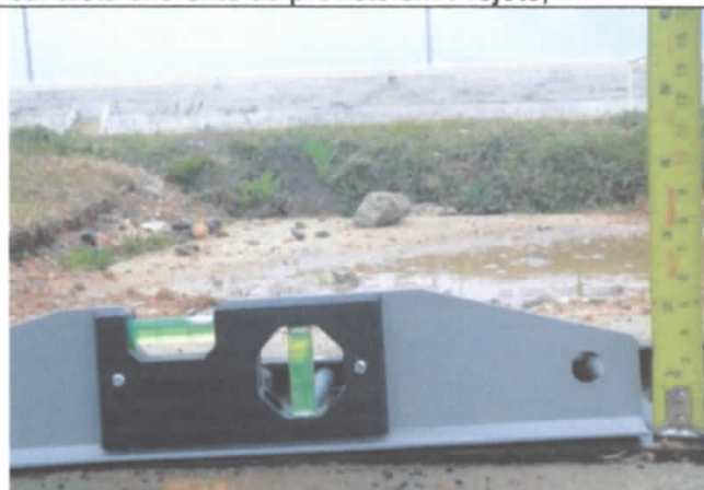
FOTO 76: Desnível entre o campo de futebol e a canaleta diferente do previsto em Projeto;
